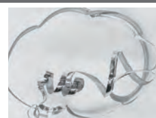
横向进给加工 ( a_p=2.0\text{mm} )
