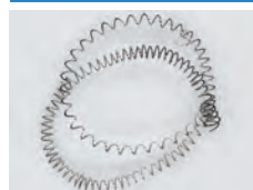
横向进给加工 ( a_p=0.15\text{mm} )
