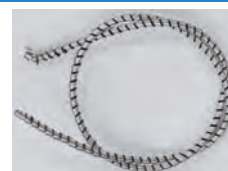
横向进给加工 ( a_p=2.0\text{mm} )
