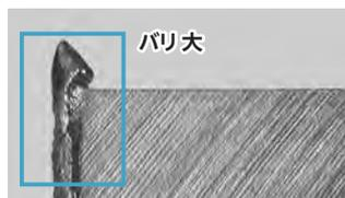
加工後のバリ状態比較 切削条件:  $n = 11,700 \text{ min}^{-1}$ ,  $V_f = 4,600 \text{ mm/min}$ ,  $a_p \times a_e = 10 \times 1 \text{ mm}$
